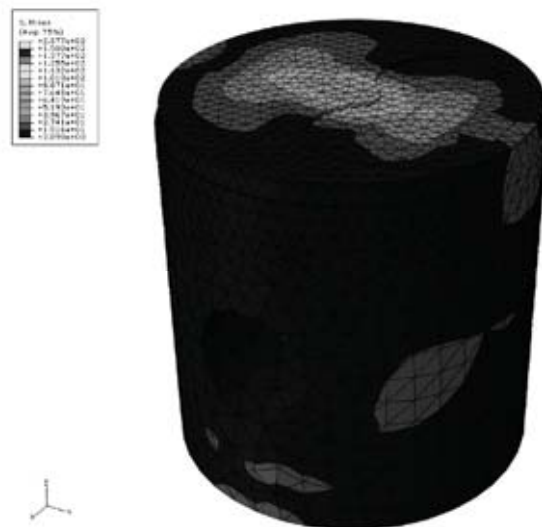
Rys. 8. Rozkład naprężeń w tłoku bez TBC Fig. 8. Stress distribution in uncoated piston
