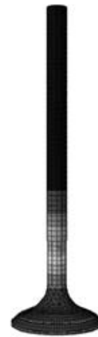
Rys. 5. Rozkład temperatury w zaworze wylotowym Fig. 5. Temperature distribution in outlet valve
